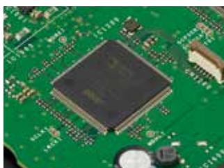
For IF DSP, transmitter ADSP-21363 clock @332MHz
